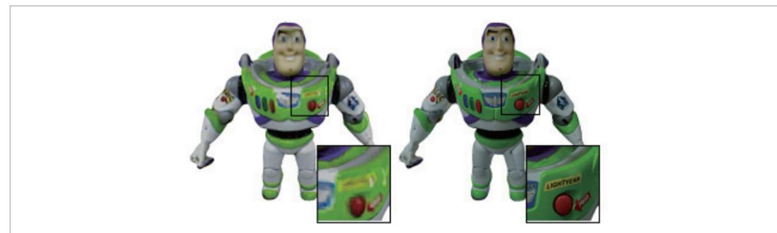
그림7 (좌) Kinect 기반 모델링 후 Kinect 입력 영상 기반 텍스처링 (우) 외부 카메라 영상을 기반으로 한 고화질 텍스처링 결과 <sup>18)</sup>
