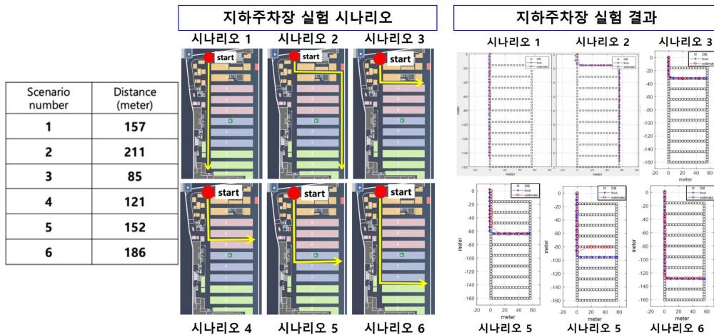
아래 <그림 27>은 6개의 실험 시나리오에서의 위치인식 결과를 정량적으로 표현한 것이다. 평균 오차는 수 미터 수준인데 반해 일부 LTE 신호 세기 변화가 미미한 구간에서는 최대 오차가 20m에 육박할 정도로 매우 크게 나타난다. 이러한 문제는 LTE 신호환경에서 기인한 것이기 때문에, LTE 신호만을 사용해서 해결하는 것이 쉽지는 않다. 우리는 이러한 문제의 해결을 위해 스마트폰 내부에 탑재된 가속도 센서와 자이로스코프 센서를 활용하고 있다.
